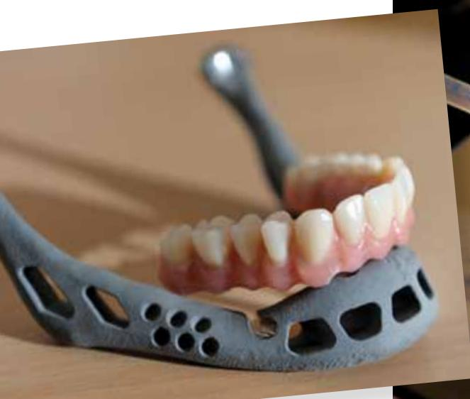
Slika 4 – 3D tiskana čeljust
