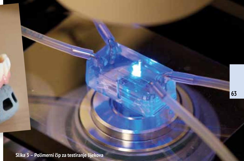
Slika 3 – Polimerni čip za testiranje lijekova
