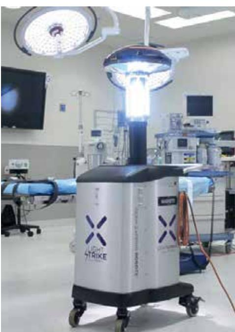
**Slika 4. Germ-Zapping robot tvrtke XENEX za dezinfekciju prostora:**
