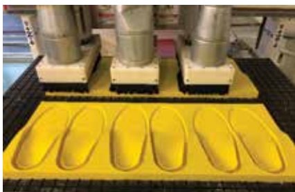
Specijalna izvedba CNC stroja za simultanu izradu više pari uložaka u jednom ciklusu
