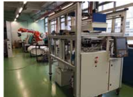
Automatizirani industrijski prototip sustava za izradu individualnih uložaka.
